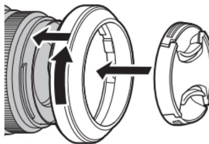
① Du er muligvis ikke i stand til at montere modlysblænden uden på tykke objektivfiltre. Vi anbefaler tynde filtre.
