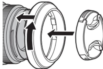
① 您可能無法在較厚的濾鏡上安裝遮光罩。建議使用較薄的濾鏡。
