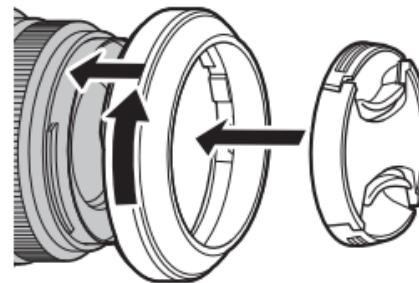
① 您可能无法在较厚的滤镜上安装遮光罩。推荐使用较薄的滤镜。
