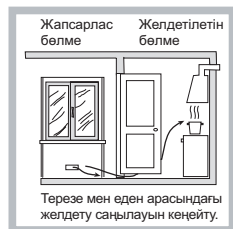
Жануға арналған ауаның желдету тесіктерінің мысалдары.
