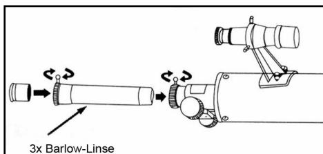
Im Lieferumfang Ihres Teleskops ist auch eine 3x Barlow-Linse enthalten, die die Vergrößerungsleistung jedes Okulars verdreifacht. Die stark vergrößerten Bilder sollten jedoch nur unter idealen Bedingungen verwendet werden – siehe den Abschnitt „Berechnung der Vergrößerung“ dieser Bedienungsanleitung. Zur Verwendung der Barlow-Linse entfernen Sie den Zenitspiegel und stecken die Barlow-Linse direkt in den Fokussiertubus. Dann stecken Sie ein Okular in die Barlow-Linse zur Beobachtung.
