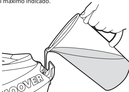
Fig. 4: Imagen del llenado del depósito de agua
