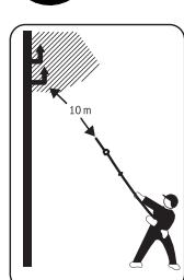
**Nigdy nie należy dotykać przewodów sieciowych lub kabli telefonicznych.** Tego typu przewody są pod bardzo wysokim napięciem. Istnieje niebezpieczeństwo porażenia prądem elektrycznym. Należy zachowywać odstęp wynoszący 10 m.
