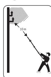
**Jamais toque em cabos eléctricos ou em cabos de telefone.** Estes cabos podem conduzir alta tensão. Há um grande risco de um choque eléctrico. Mantenha no mínimo uma distância de 10 m.
