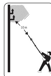
**Nikdy sa nedotýkajte elektrických ani telefónnych kálov.** Takéto káble môžu byť pod prúdom a vieť vysoké napätie. Hrozí akútne nebezpečenstvo zásahu elektrickým prúdom. Udržiavajte minimálny odstup 10 m.
