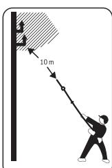
**Ne dodirujte nikada strujni ili telefonski kabl.** Takvi vodovi provode visoki napon. Postoji akutna opasnost od električnog udara. Održavajte najmanje rastojanje od 10 m.
