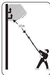
**Nikada ne dodirujte električne ili telefonske kablove.** Takvi vodovi mogu biti pod visokim naponom. Postoji opasnost od strujnog udara. Održavajte minimalni razmak od 10 m.
