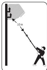
**Nepieskarieties elektrokabeliem vai sakaru kabeliem.** Pa šiem vadiem tiek pārvadīts augsts spriegums. Pieskaroties tiem, pastāv risks sanemt elektrisko triecienu. Ieturiet vismaz 10 m lielu attālumu no tiem.
