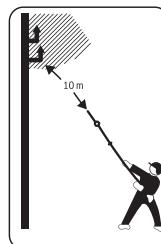
**Berør aldrig strøm- eller telefonledninger.** Sådanne ledninger fører til høj spænding. Akut fare for elektrisk stød. Hold en afstand på mindst 10 m.
