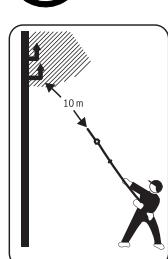
**Berühren Sie niemals Strom- oder Telefonkabel.** Solche Leitungen führen eine hohe Spannung. Es besteht die akute Gefahr eines elektrischen Schlags. Halten Sie mindestens einen Abstand von 10 m.
