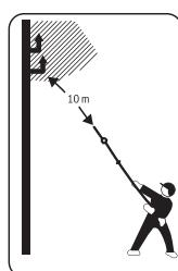
**Никогда не касайтесь электрических и телефонных кабелей.** По этим проводникам идет ток высокого напряжения. Существует высокая опасность поражения электрическим током. Соблюдайте дистанцию минимум в 10 м.
