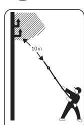
**Nu atingeți în niciun caz cu scula electrică cablurile de curent sau cele de telefonie.** Astfel de cabluri se află sub înaltă tensiune. Există pericol crescut de electrocutare. Păstrați o distanță minimă de 10 m față de acestea.
