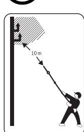
**Jamás toque cables eléctricos ni teléfonicos.** Estos cables se encuentran bajo una alta tensión. Corre un gran riesgo de exponerse a una descarga eléctrica. Mantenga una separación mínima de 10 m.
