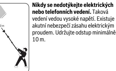
**Nikdy se nedotýkejte elektrických nebo telefonních vedení.** Taková vedení vedou vysoké napětí. Existuje akutní nebezpečí zásahu elektrickým proudem. Udržujte odstup minimálně 10 m.
