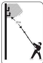
**Non toccare mai cavi elettrici o cavi telefonici.** Tali cavi conducono una tensione elevata. Esiste il forte pericolo di una scossa elettrica. Tenersi ad una distanza minima di 10 m.
