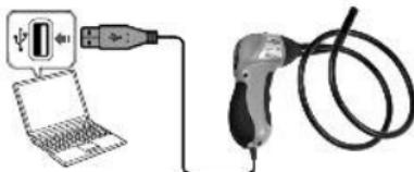
Anslut inspektionskameran till en USB-port när datorn begär det. Följ instruktionerna på skärmen för att installera programvaran. Om ett meddelande avseende Windows-kompatibilitet visas, klicka på 'Fortsätt ändå'. Starta om datorn på begäran för att slutföra installationen.
