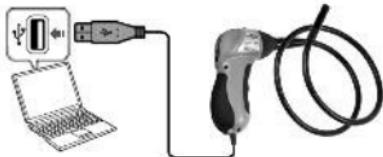
Inspektionskamera am USB-Anschluss anschließen, wenn hierzu eine entsprechende Aufforderung erscheint. Anweisungen auf dem Bildschirm befolgen, um die Software zu installieren.
