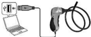
Conecte la cámara de inspección al puerto USB cuando se le indique. Sigas las instrucciones en pantalla para instalar el software. Si aparece un mensaje de compatibilidad de Windows, haga clic en "Continue anyway" (Continuar de todos modos). Reinicie el ordenador cuando se le indique para completar la instalación.
