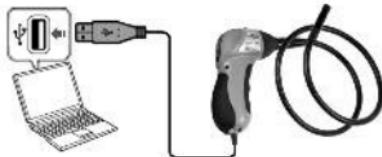
Sluit de inspectiecamera aan op de USB poort wanneer daarom wordt gevraagd. Volg de instructies op het scherm voor de installatie van de software. Indien het Windows Compatibiliteitsbericht verschijnt klik dan op 'Toch doorgaan'. Re-boot de computer wanneer gevraagd wordt de installatie te voltooien.
