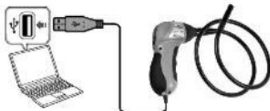
Ligue a câmara de inspecção à porta USB quando lhe for solicitado. Siga as instruções indicadas no ecrã para instalar o programa. Se aparecer uma mensagem de compatibilidade do Windows, clique em "Continue anyway". Reinicie o computador quando lhe for solicitado para concluir a instalação.
