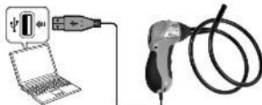
Podłącz kamerę inspekcyjną do portu USB, kiedy zotaniesz o to poproszony. Aby zainstalować oprogramowanie, postępuj zgodnie z instrukcjami wyświetlanymi na ekranie. W przypadku pojawiienia się komunikatu o zgodności z systemem Windows, kliknij "Kontynuuj mimo to". Kiedy zotaniesz o to poproszony, uruchom ponownie komputer, aby dokonać instalacji.
