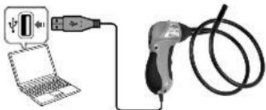
Collegare la telecamera d'ispezione alla porta USB quando richiesto. Seguire le istruzioni a schermo per installare il software. Se viene visualizzato il messaggio di compatibilità di Windows cliccare su 'Continua comunque'. Riavviare il computer quando richiesto per completare l'installazione.
